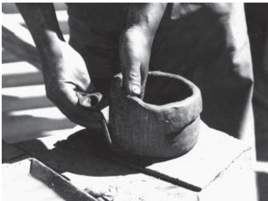
Figura 9. Se alisa el rodete y la unión con la karaña. The coil and joint are polished with the karaña.
