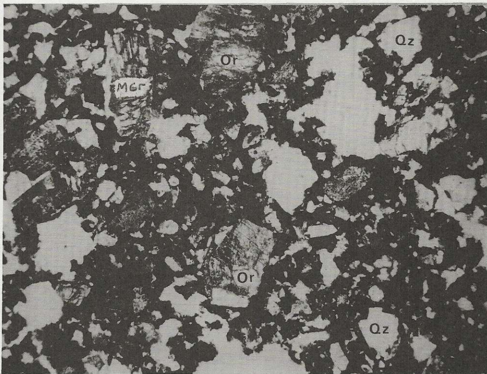
M1: Sección delgada de la muestra de cerámica M-1. Nicholes paralelos. 47x. zona oscura: arcilla; MGr: Microgranito gráfico; Qz: Cuarzo; Or: Ortoclasa.
