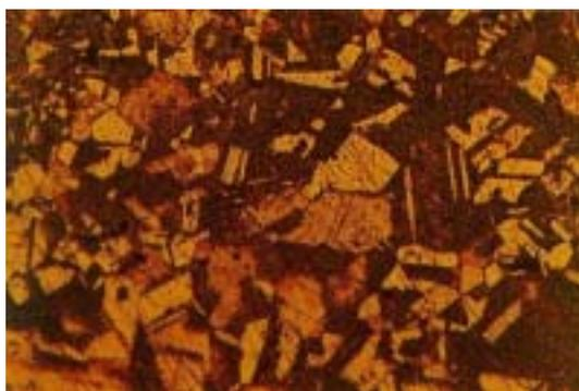
Figura 4. Maza MI 1 100X. Fundición a la cera perdida. Los límites de grano son claros, lo que indica un lento enfriamiento en molde aislado.
